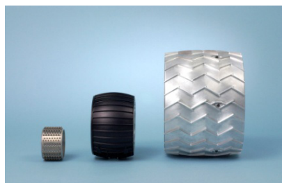
Рис. 5. Сравнение колес марсоходов «Соджорнер», «Спирит», «Кьюриосити»
