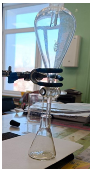
Рис. 6. Использование делительной воронки и полученный продукт
