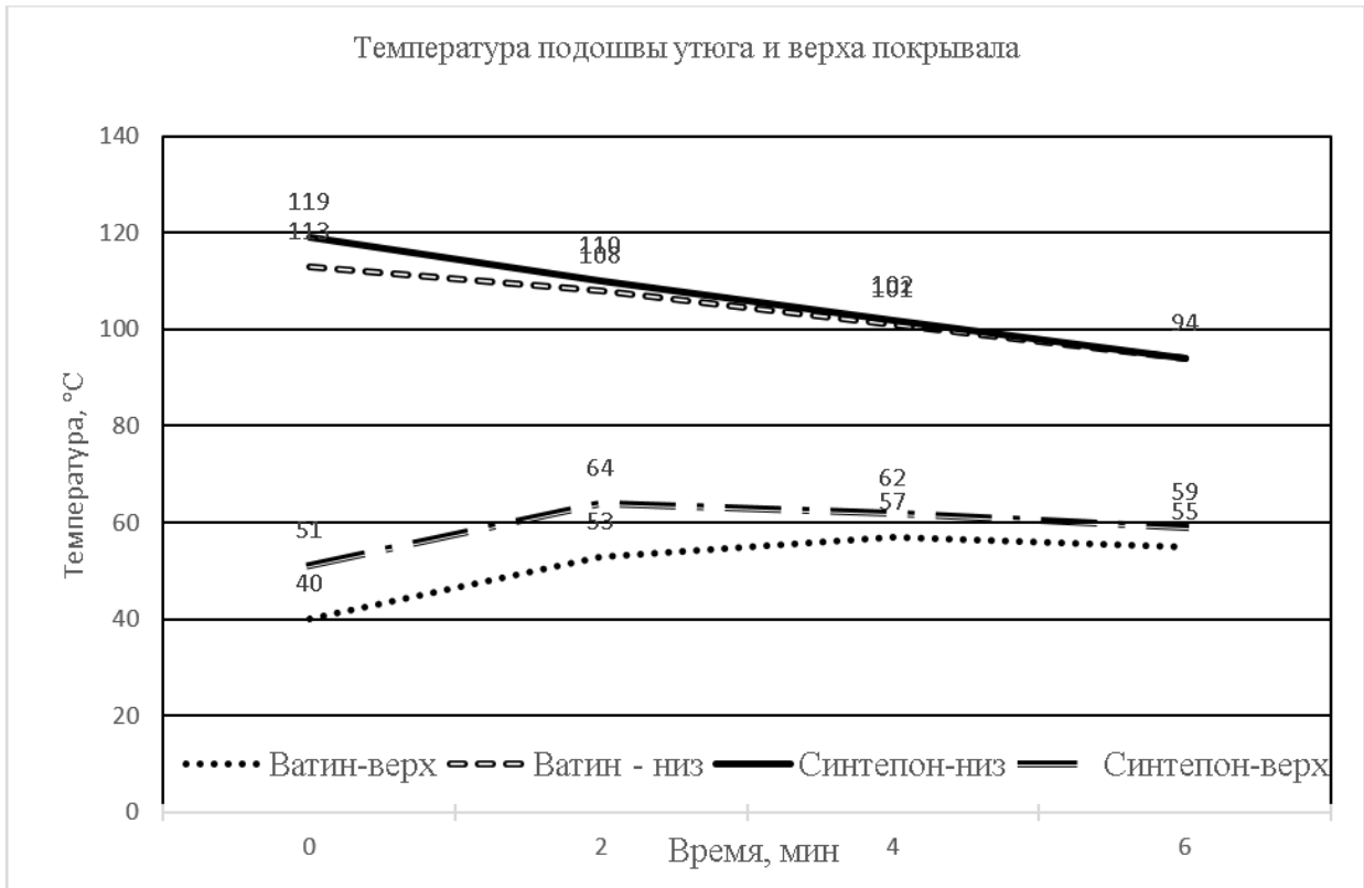
Рис. 8. Зависимость температуры охлаждения подошвы утюга и верха покрывала от промежуточного слоя в покрывале
