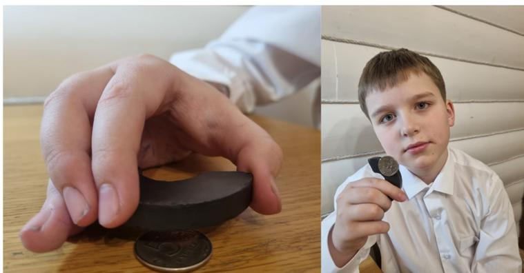
Рис. 2. Монеты номиналом 5 рублей, изготовленные из меди с мельхиоровым покрытием (а), из стали с никелевым покрытием (б).
