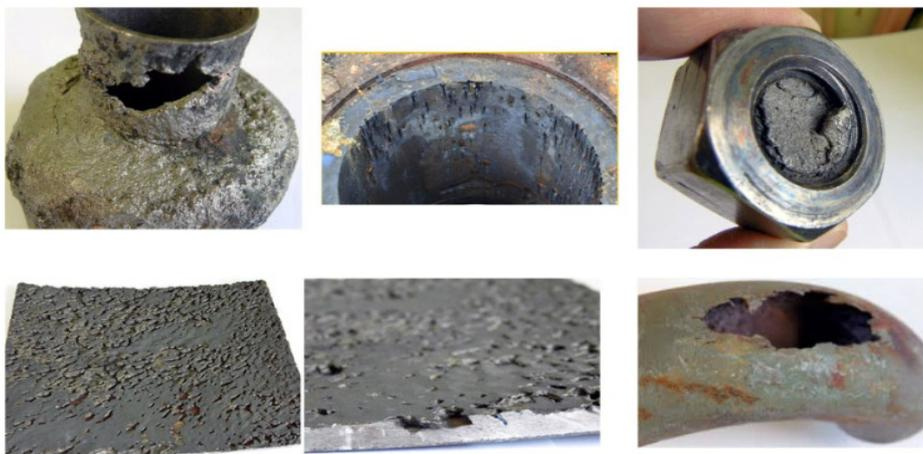
Рис. 1. Результат воздействия геотермальной воды на металл
