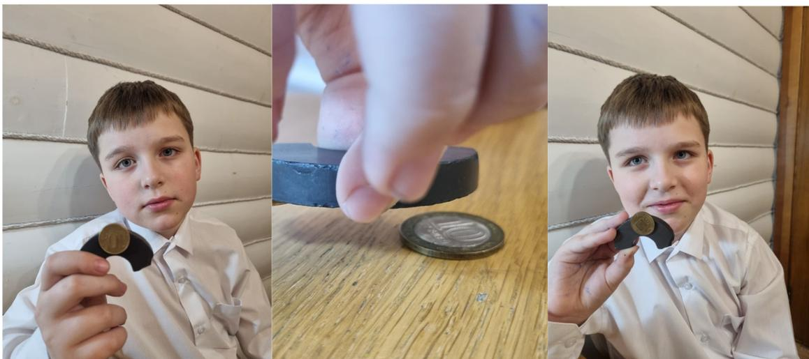
Рис. 1. Монеты номиналом 10 рублей, изготовленные из стали с латунным покрытием (а), из латуни со вставкой из мельхиора (б), из стали с никелевым и латунным покрытием (в)
