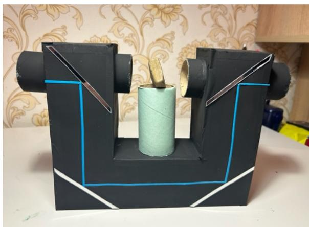
Рис. 2. Схема п-образной конструкции для эксперимента по преломлению света [3]
