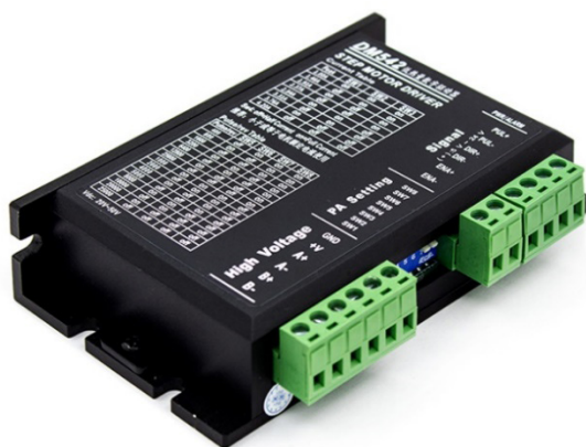
Рис. 11. Драйвер шагового двигателя DM542S
