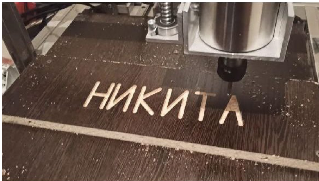
Рис. 19. Тестовый запил фигуры с использованием G-кода
