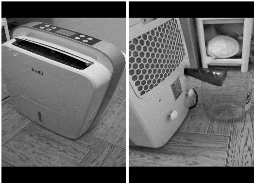
Рис. 12. Получение воды на АВГ Ballu
