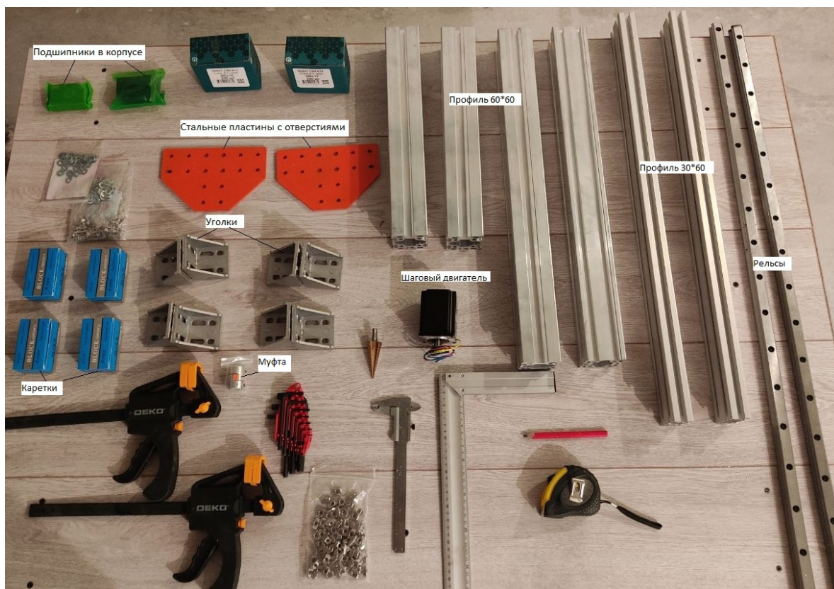
Рис. 2. Материалы для сборки рамы
