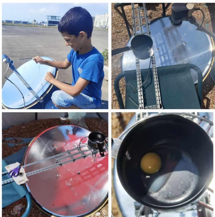
Фото 9. Солнечный концентратор из спутниковой тарелки
