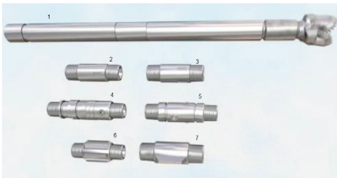
Рис. 2. Забойный двигатель отклонитель с дополнительными секциями. 1. Двигатель отклонитель; 2. Прямой переводник; 3. Искривленный переводник; 4. Регулируемый механизм искривления; 5. Шарнир с двумя степенями свободы; 6. Центратор; 7. Децентратор.
