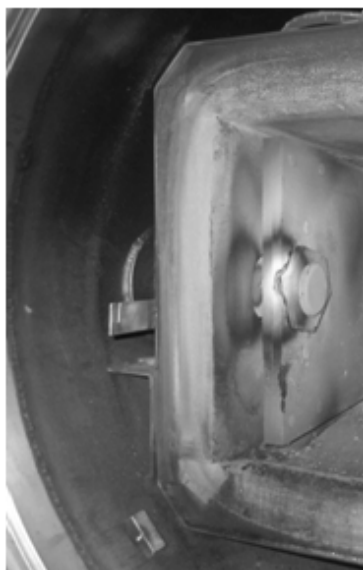
Рис. 3. Разрушение углеродного нагревателя печи ВОЖ-16–22 после проведения экспериментов с \text{CO}_2
