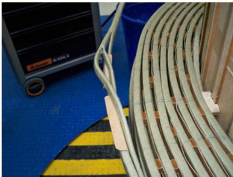
Рис. 3. Намотка непрерывной катушечной обмотки «Смит»
