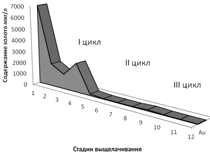
Рис. 3. Распределение золота в растворах выщелачивания с низкотемпературной обработкой в СВЧ поле (Березовская ЗИФ)
