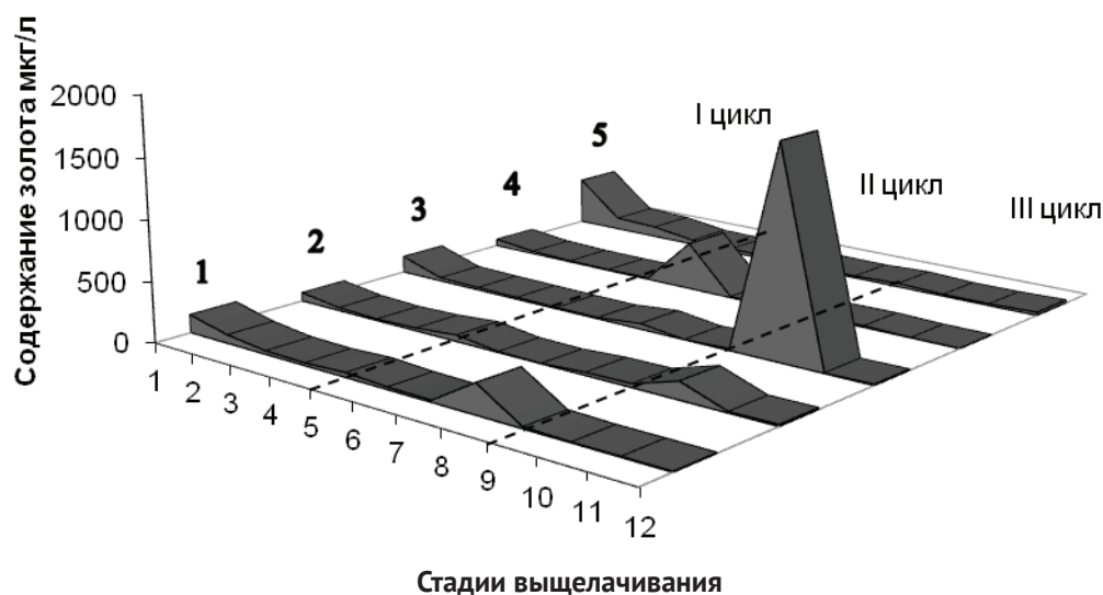
Рис. 1. Распределение золота в растворах выщелачивания с низкотемпературной обработкой в СВЧ поле (образцы Гайского ГОКа)
