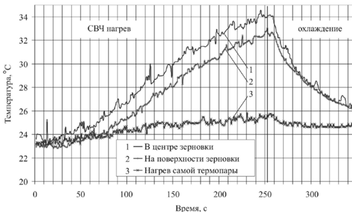
Рис. 3. Графики изменения температуры в центре и на поверхности зерновки пшеницы при СВЧ-воздействии для W_3=14\%
