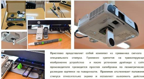
Приставка представляет собой комплект из приемника сигнала и специального стилуса. Приемник крепится на транслирующее изображение устройство и после установки драйвера с сайта производителя проводится простая калибровка по геометрическим размерам картинки на поверхности. Приемник отслеживает положение стилуса относительно экрана и позволяет выполнять действия аналогичные действиям с помощью «мышки».
