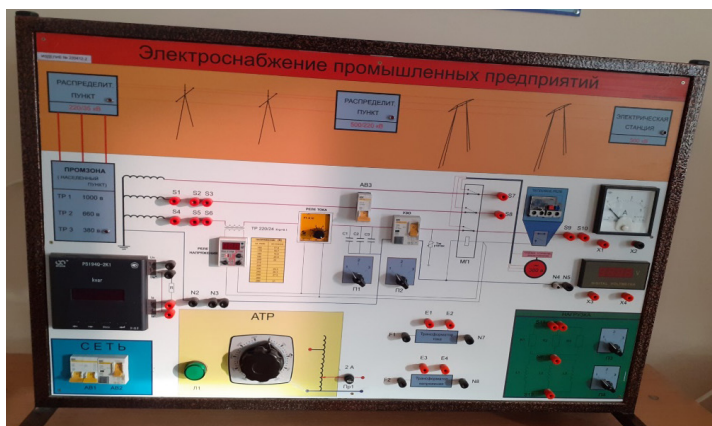
Рис. 1. Лабораторный стенд «Электроснабжение промышленных предприятий»
