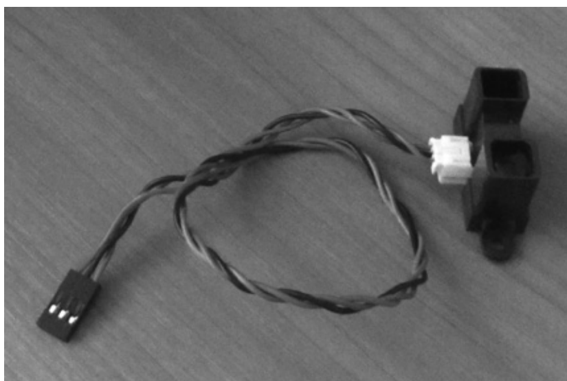
Рис. 3. Аналоговый датчик расстояния
