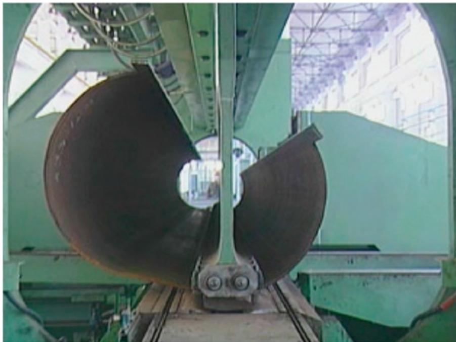
Рис. 2. Формовка правой части изогнутой заготовки на трубном прессе
