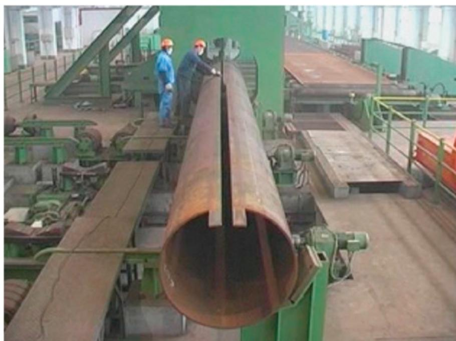
Рис. 4. Вид заготовки после формовки на трубном прессе
