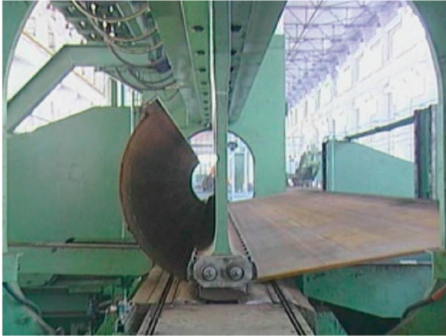
Рис. 1. Формовка левой части изогнутой заготовки на трубном прессе
