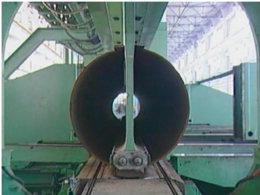
Рис. 3. Формовка середины изогнутой заготовки на трубном прессе
