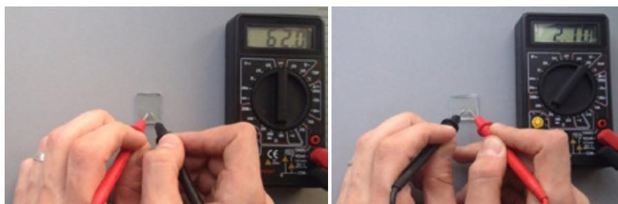
а) образец с покрытием  $SnO_2$  б) образец с покрытием АТО
