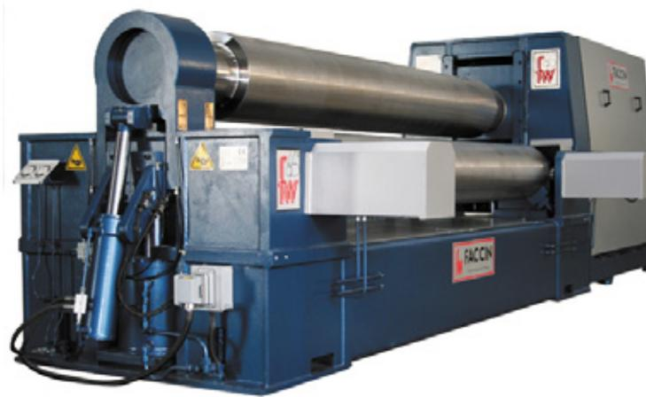
Рис. 1. Трехвалковые вальцы с гидравлическим приводом
