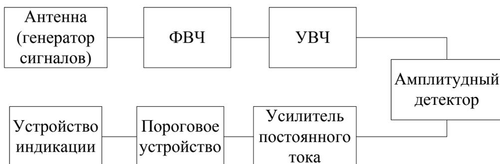
Рис. 1. Структурная схема модели детектора сигналов средств беспроводного доступа
