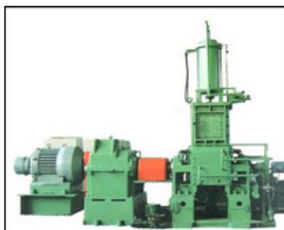
Рис. 4. Резиносмеситель для жестких резин с роторами типа интермикс
