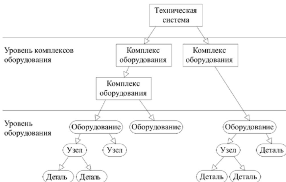
Рис. 1. Иерархическая структура технической системы
