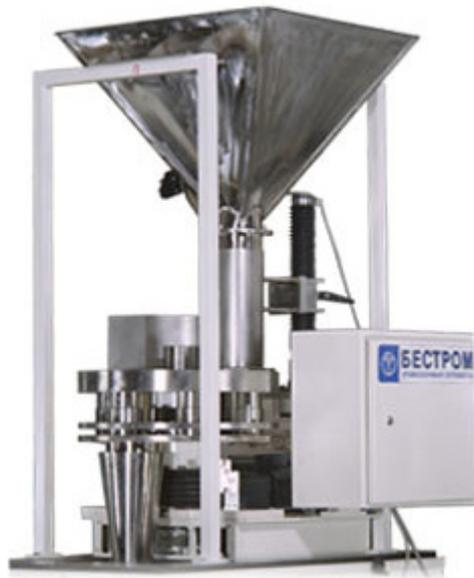
Рис. 2. Объемный стаканчиковый дозатор «Бестром-3500»
