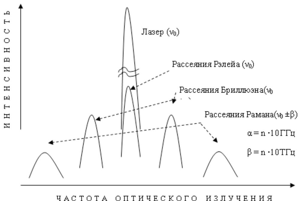
Рис.2. Спектры рассеяния лазерных лучей в световодах с БР
