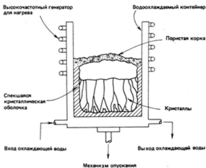
Рис. 2. Расположение кристаллов внутри контейнера после охлаждения
