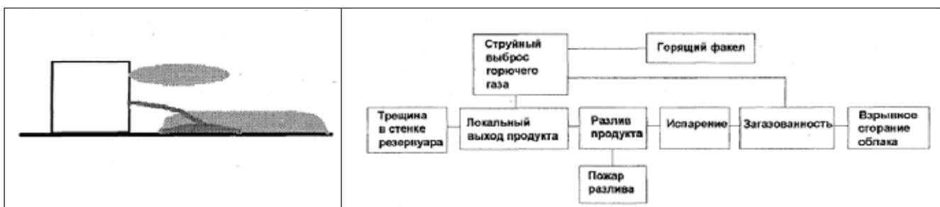
Рис. 2. Дерево событий при локальном разрушении резервуара
