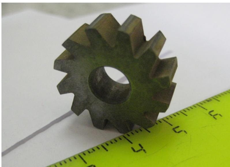
Рис. 3. Заготовка мелко модульной твердосплавной червячной фрезы с вырезанными стружечными канавками на электроэрозионном станке
