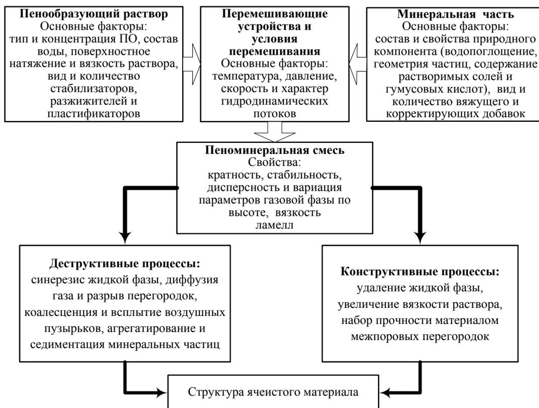
Рис. 1. Основные факторы, определяющие структуру и свойства ячеистого сырца
