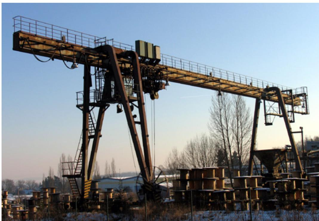
Рис. 1 Общий вид козлового крана (г/п 12 т.)
