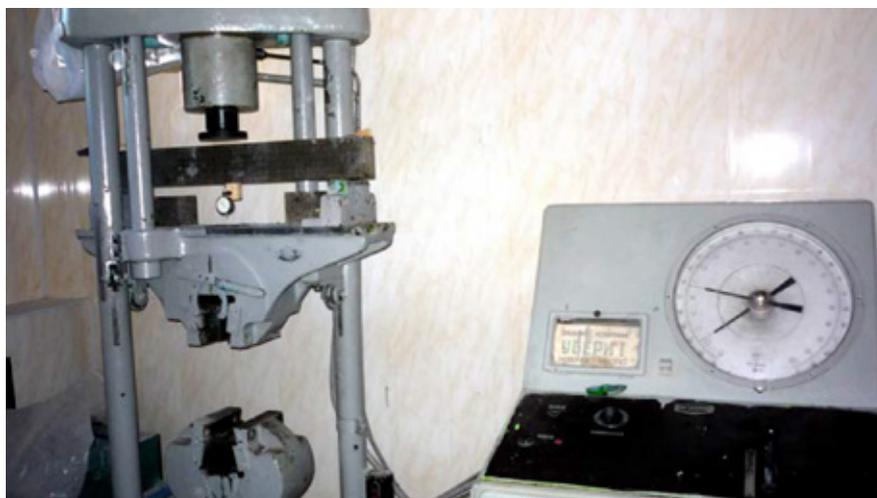
Рис. 2. Испытание балки на испытательной машине УММ-50
