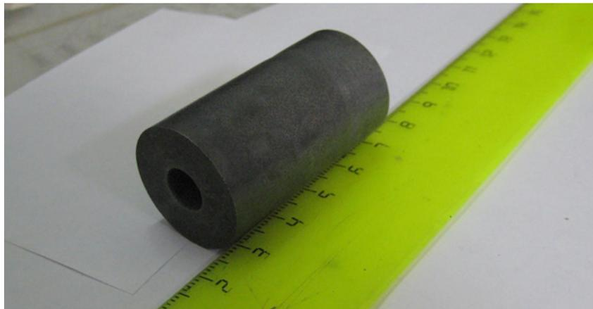
Рис. 1. Заготовка из спеченного твердого сплава под мелко модульную червячную фрезу
