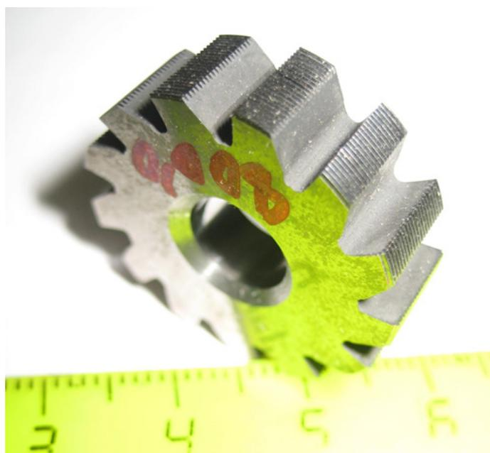
Рис. 4. Затылованная мелко модульная твердосплавная червячная фреза
