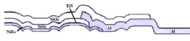
Рис. 2. Магниторезистивная структура
