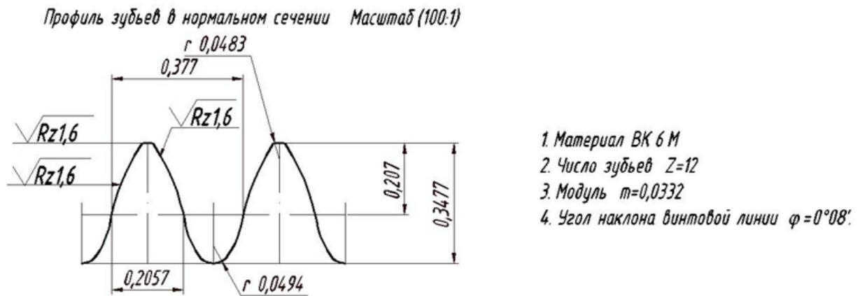
Рис. 6. Профиль зубьев фрезы
