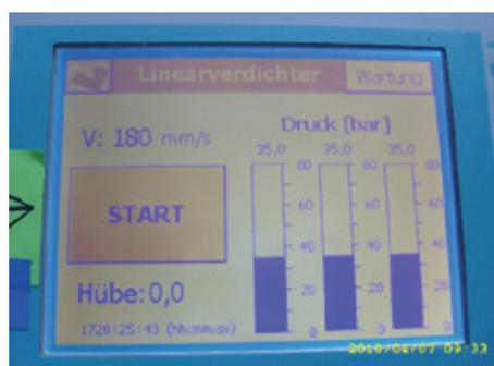
Рис. 2. Блок управления компрессором и сенсорный дисплей блока управления
