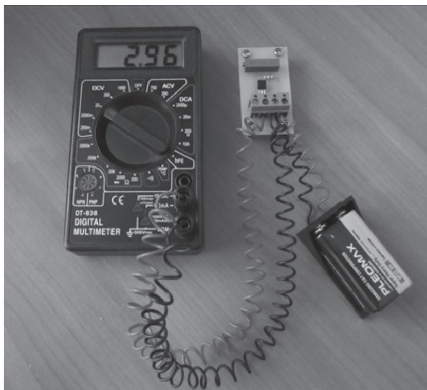
Рис. 3. Аналоговый датчик температуры, мультиметр и батарея
