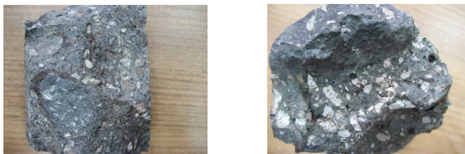
Рис.1. Многочисленные вкрапленники ортоклаза в образцах керна № 21, №22
