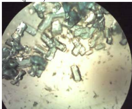
Рис.1. Микрофотография \text{Na}_3[\text{CoMo}_6\text{O}_{18}(\text{OH})_6] \cdot 8\text{H}_2\text{O} .
