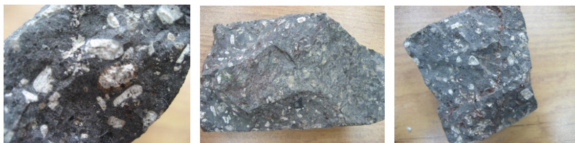
Рис.3. Выполненные гематитом каемки, области и трещины в образцах керна №№ 28, 32, 33
