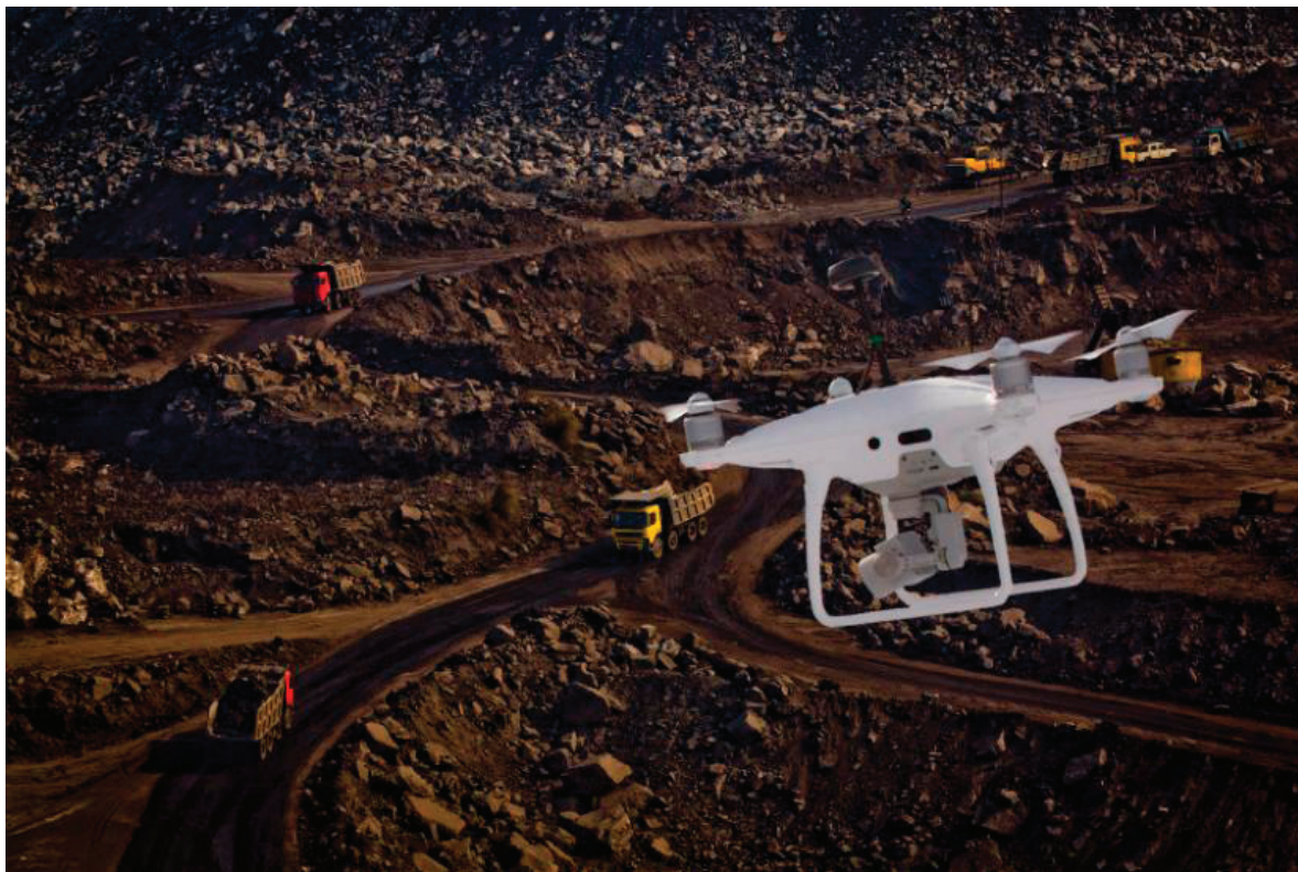
Рис. 5. БПЛА DJI PHANTOM 4 PRO RTK-PPK, используемый для аэрофотосъемки строительных объектов.
