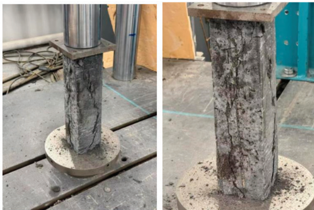
Рис. 4. Состояние разрушения призмических образцов со стальной фиброй в процессе испытания на сжатие
