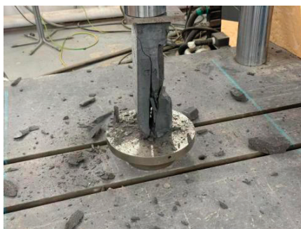
Рис. 5. Состояние разрушения призмических образцов без фибры при испытании на сжатие
