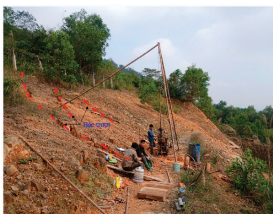
б. Ступени скольжения в левой части откоса
