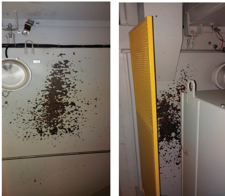
Рис. 1. Примеры повреждения лакокрасочного покрытия песочного бункера
