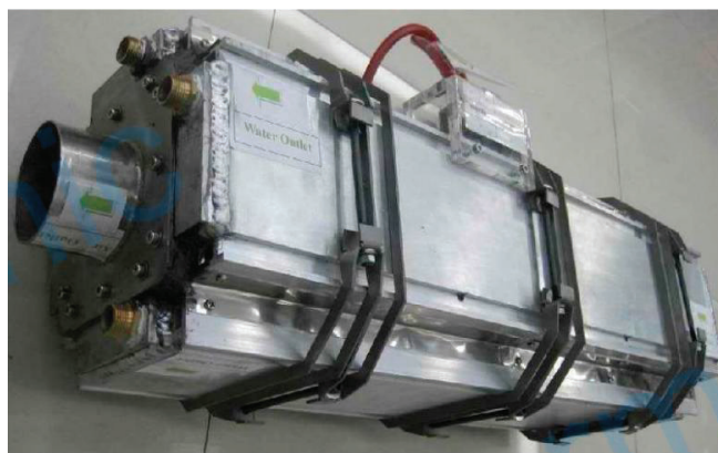
Рис. 5. Термоэлектрический генератор с рекуперацией тепла от горячего газа TEG-HL350–48 V
