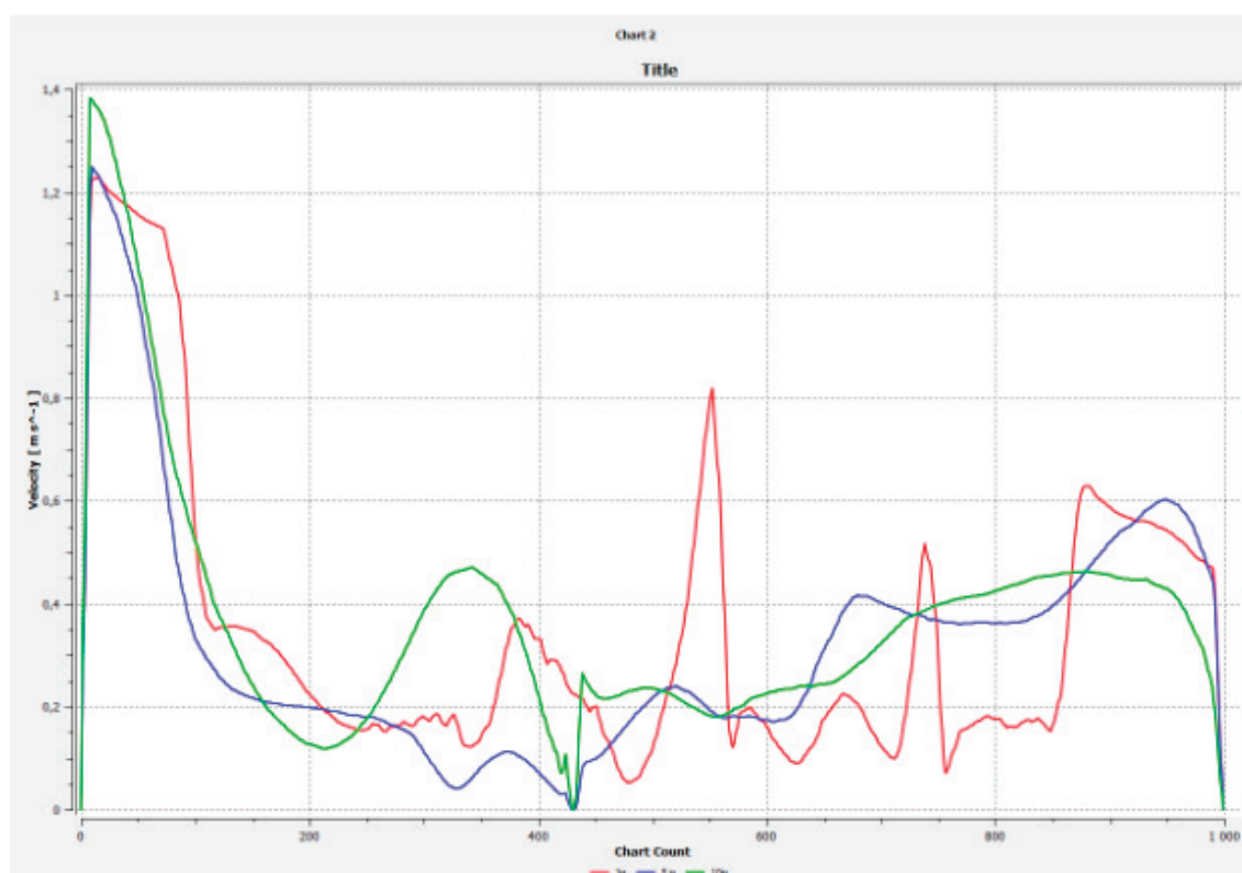
Рис. 5. График распределения скоростей по поперечной горизонтальной прямой в 1, 5, 10 метров от пола
