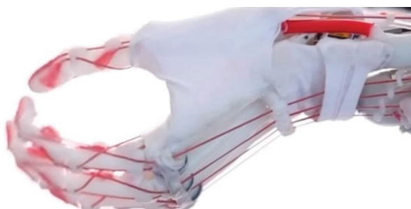
Рис. 4. Рука андроида с тросовыми приводами
