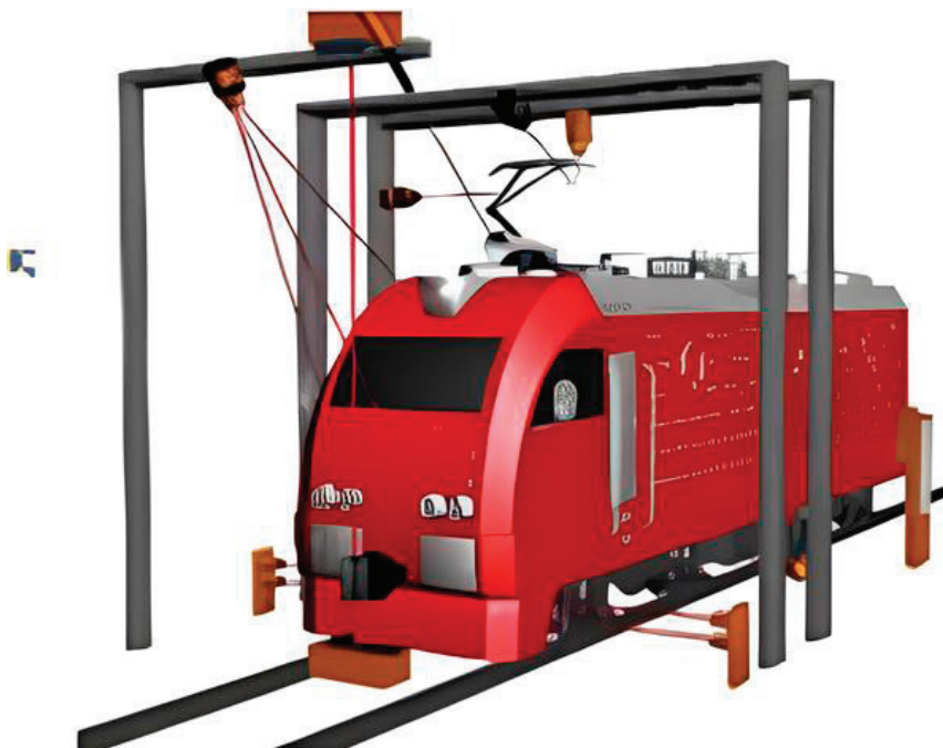
Рис. 7. Реальная концепция прохождения предиктивной диагностики при въезде в депо
