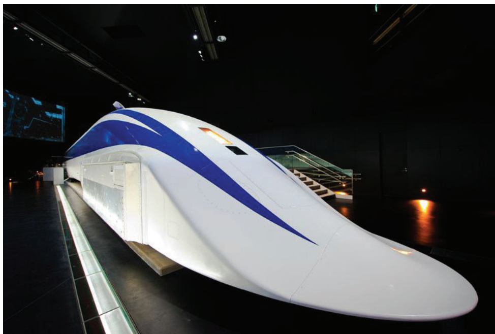
Рис. 5. Вытянутая каплевидная форма зарубежного подвижного состава «JR-Maglev»
