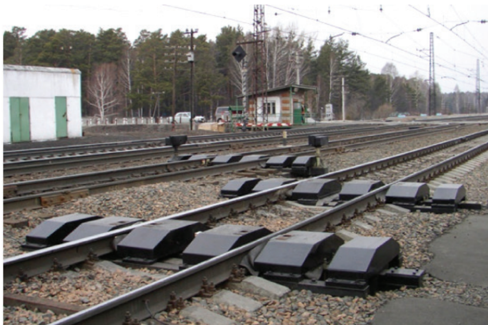
Рис. 1. Диагностическая система «Комплекс» на подходе к ПТО «Инская»
