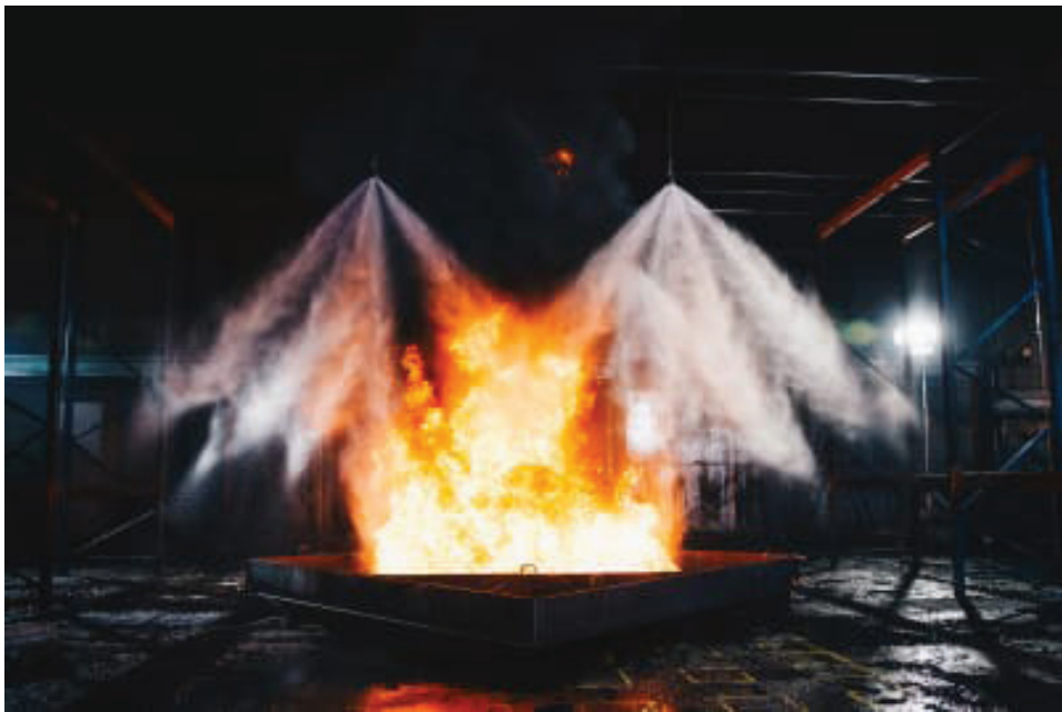
Рис. 2. Тушение пламени тонкораспыленной водой
