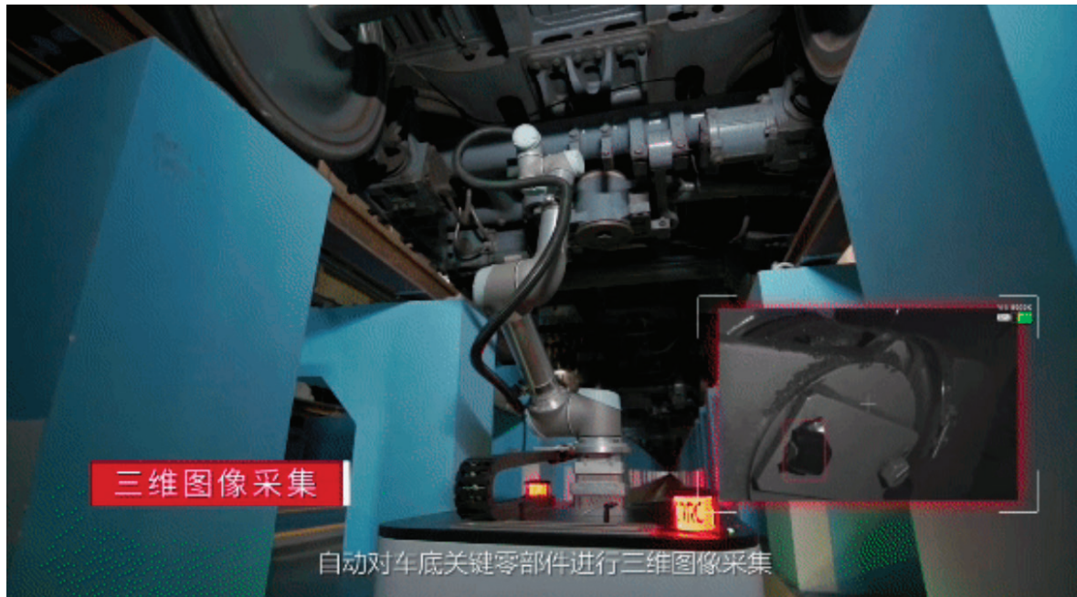
Рис. 4. Интеллектуальный инспекционный робот производства CRRC Sifang осуществляет сканирование тележного оборудования поезда в электродепо Ухань
