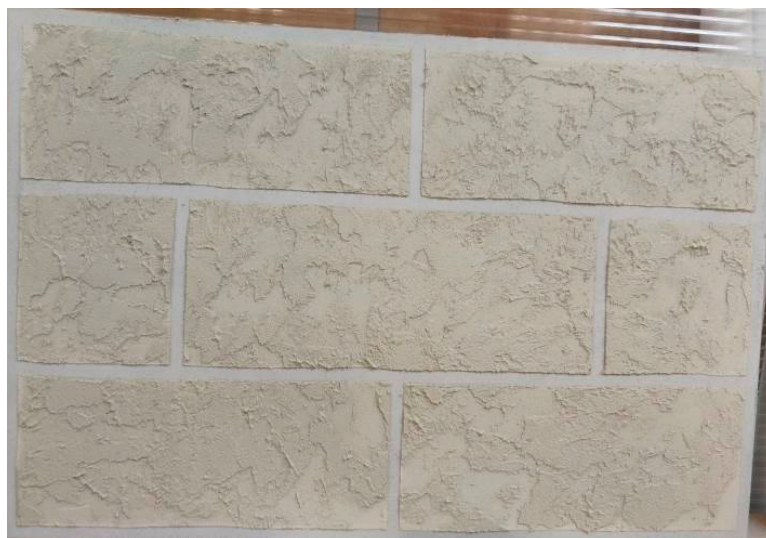
Рис. 5. Внешний вид имитации фактуры каменной кладки
