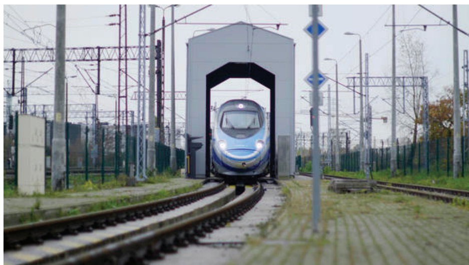
Рис. 3. Trainscanner от Alstom для поезда в Польше
