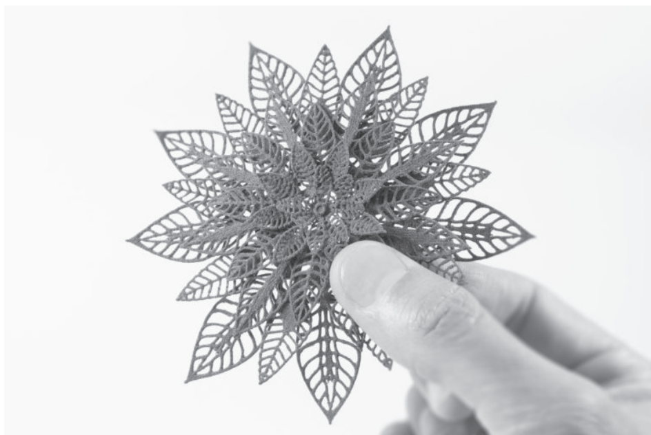
Рис. 6. Изделие, изготовленное SLS-методом
