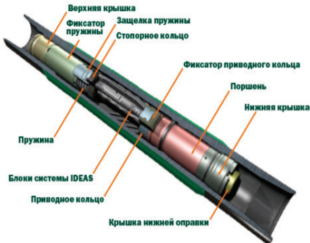
Рис. 1. Конструкция гидравлического расширителя Rhino XS
