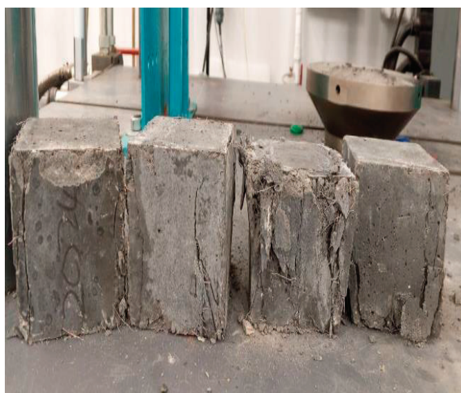
Рис. 7. Общий вид разрушенных образцов серии В30.1,85 %
