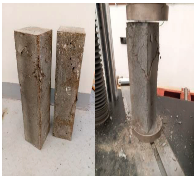
Рис. 6. Общий вид разрушенных образцов серии В30.1,85 %
