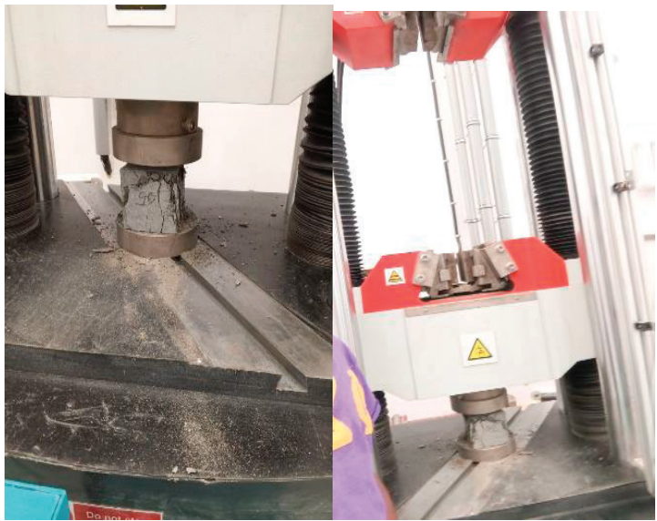
Рис. 9. Общий вид разрушенных образцов серии В30.0 %
