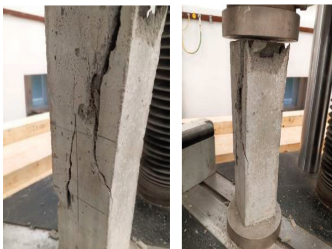
Рис. 8. Общий вид разрушенных образцов серии В30.0 %
