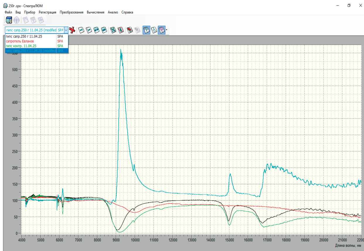
Рис. 4. График спектрального анализа образцов контрольного (1) и с сапропелем 250 г (7)
