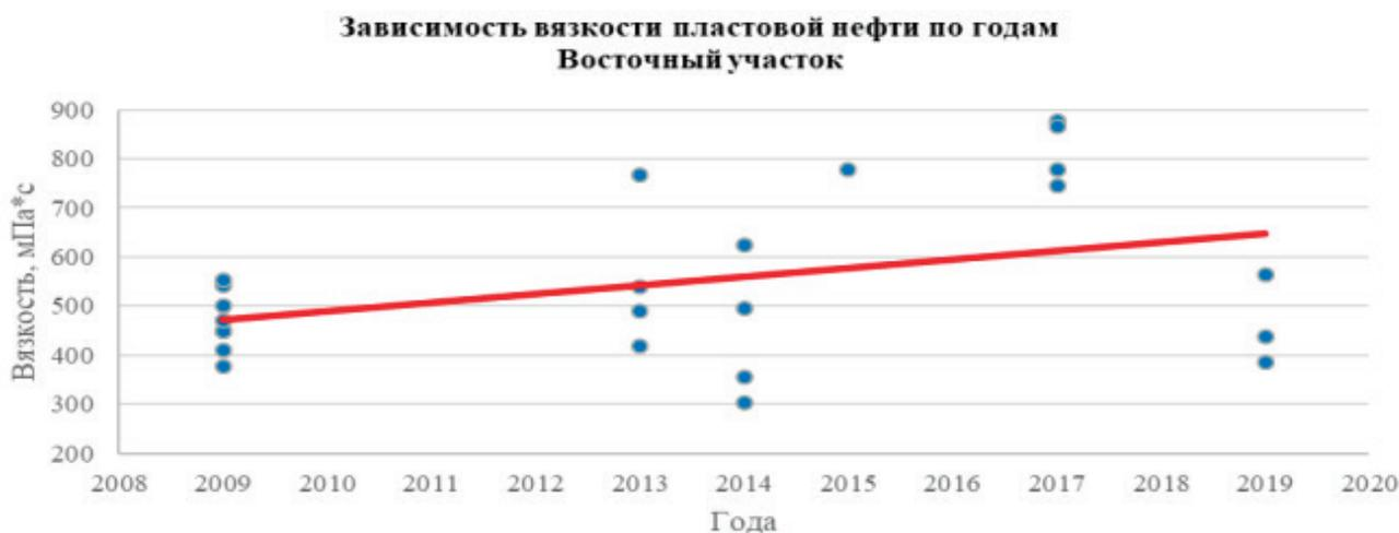
Рис. 1. График изменения вязкости пластовой нефти по годам в различных зонах воздействия. Восточный участок — закачка пара, зона сочленения — закачка пара и закачка воды
