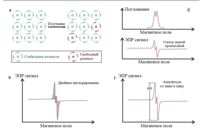
Рисунок 1. Принципы ЭПР-дозиметрии. a) Принципиальная схема образования свободных радикалов при облучении. б) Спектры поглощения и его первые производные спектры ЭПР-дозиметра после облучения. в) Оценка поглощенных доз на основе метода «двойного интегрирования». г) Оценка поглощенных доз на основе метода «амплитуда от пика к пику»
