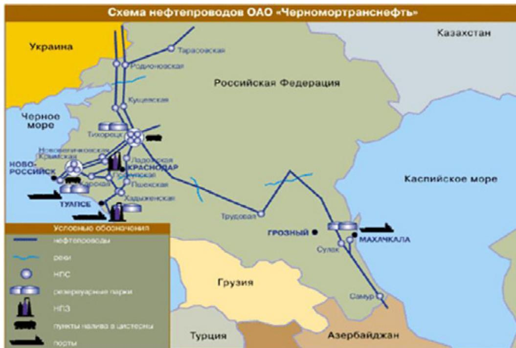
Рис. 1. Схема нефтепроводов ОАО «Черномортранснефть»
