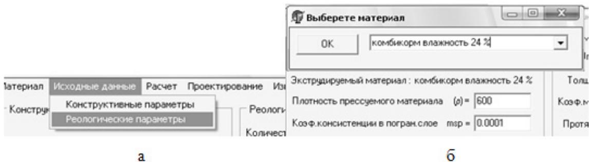
Рис. 4. Задание реологических параметров обрабатываемого материала: а — выбор подпункта меню, б — интерфейс ввода
