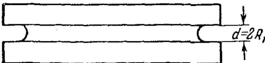
Рис. 2. Схема возникновения сил сцепления
