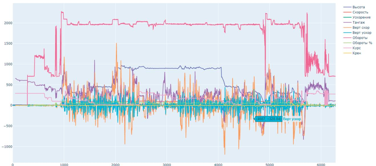
Рис. 1. Отображение записанных комплексом Garmin-G1000 данных
