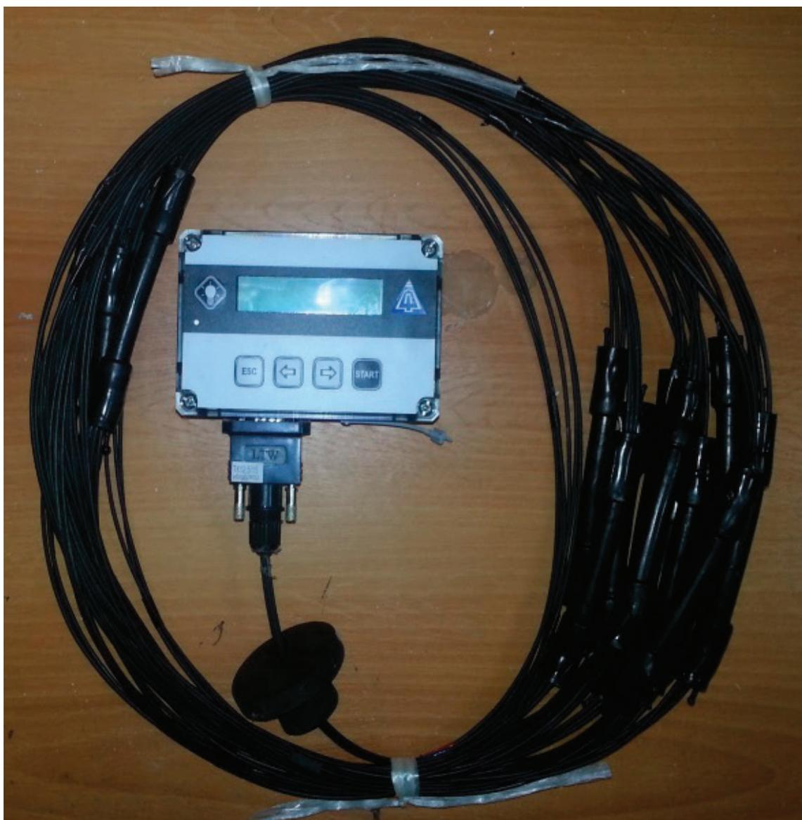
Рис. 2. Термокоса PRC и портативный контроллер TKS61
