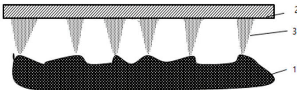
Рис. 1. Обрабатываемый материал, 2 — ВЧ электрод, 3 — плазма
