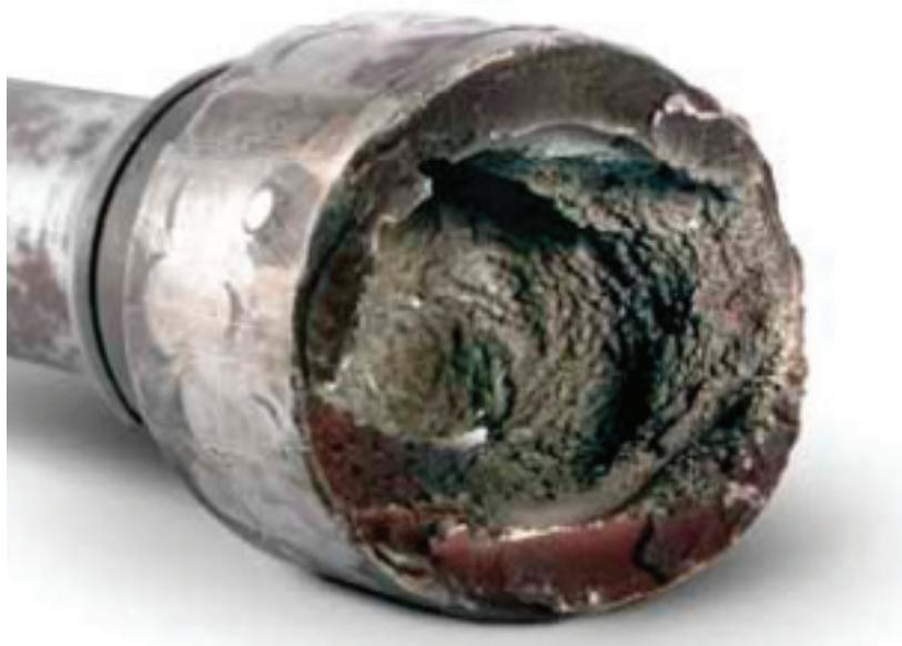
Рис. 1. Последствия кавитационного износа плунжера
