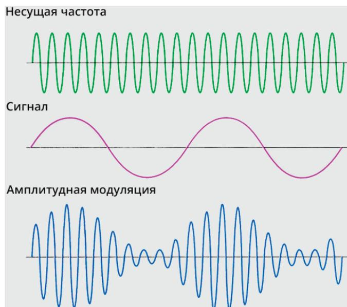
Рис. 1. Амплитудная модуляция
