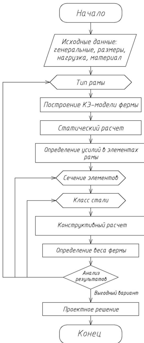
Рис. 1. Блок-схема алгоритма расчета стропильной фермы при вариантном проектировании
