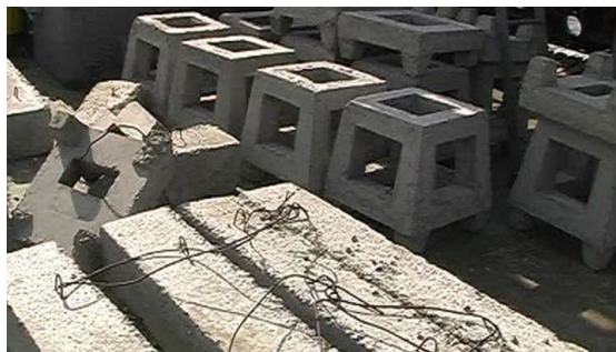
Рис. 6. Модульная бетонная биостанция перед установкой [14]
