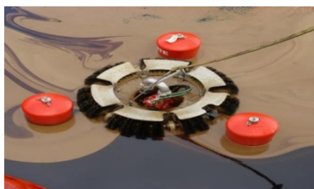
Рис. 9. Скимминг включает в себя использование различных инструментов и оборудования для физического отделения нефти от воды и помещения нефти в резервуары для сбора. Скиммеры предназначены для сбора нефти в резервуары. Фото: @desmi
