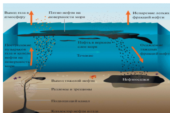
Рис. 2. Схематическое представление источника естественного нефтепроявления и его особенностей [13]
