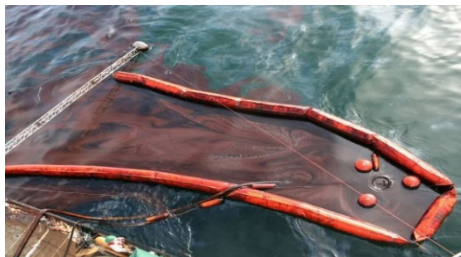
Рис. 8. Боновые заграждения представляют собой временные плавучие барьеры, удерживающие разлив нефти. Они в основном используются в форме надувных труб. Они используются, чтобы окружить нефть и направить разлив нефти в нужную сторону. Фото: @dprom. online
