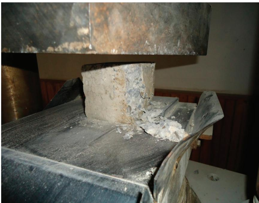
Рис. 2. Определение прочности бетонных кубов в гидравлическом прессе
