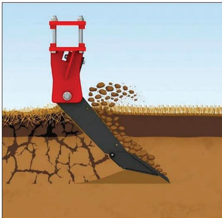
Рис. 1. Рабочий орган глубокорыхлителя разрушает плужную подошву
