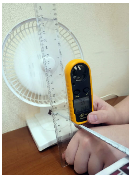
Рис. 4. Источник и приёмник воздушного потока, измерение расстояние между ними
