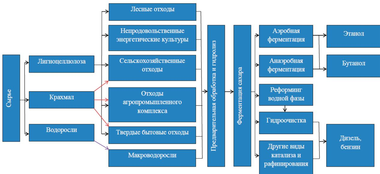
Рис. 2. Получение сырья и процесс производства жидкого биотоплива
