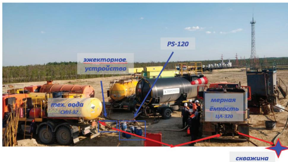
Рис. 3. Схема проведения ОПЗ с применением отклонителя R-120
