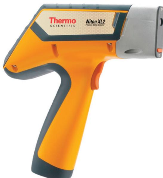
Рис. 5. Спектрометр NITON XL2
