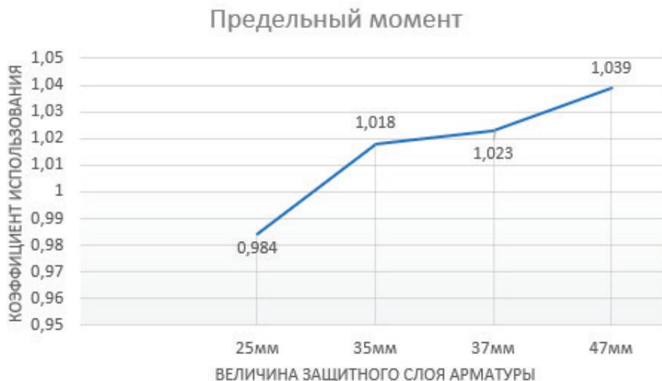
Рис. 5. Коэффициент использования по предельному моменту (п.п. 8.1.8–8.1.14 СП 63.13330.2018)
