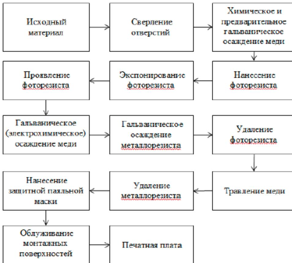
Рис. 1. Традиционная технология изготовления двухсторонней печатной платы
