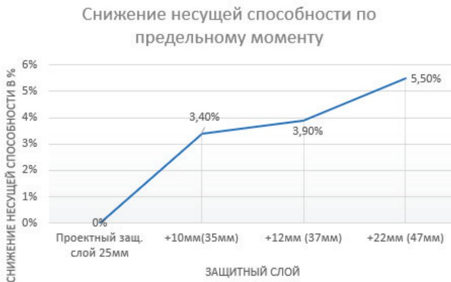
Рис. 6. Снижение несущей способности по предельному моменту
