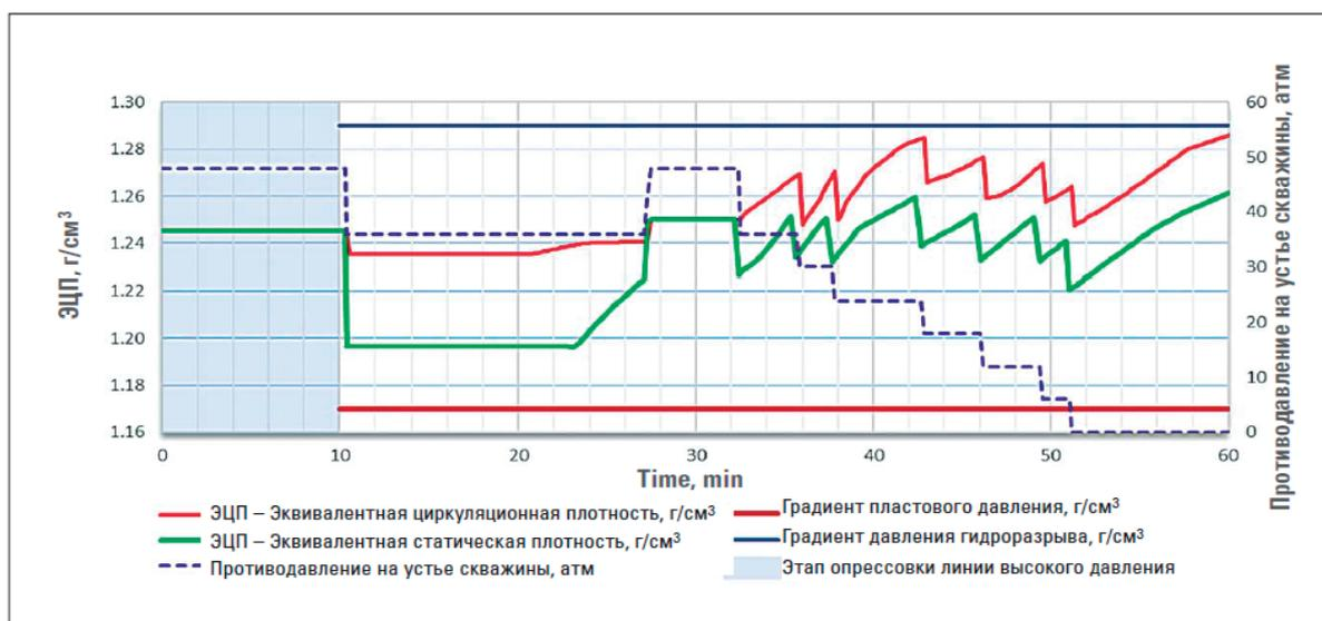
Рис. 2. Динамика ЭЦП и противодействия в процессе цементирования
