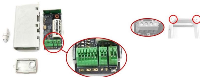
Рис. 5. Снятие корпуса радиомодема
