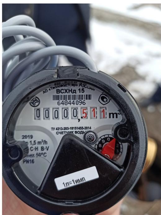
Рис. 2. Купленный счетчик воды с импульсным выходом
