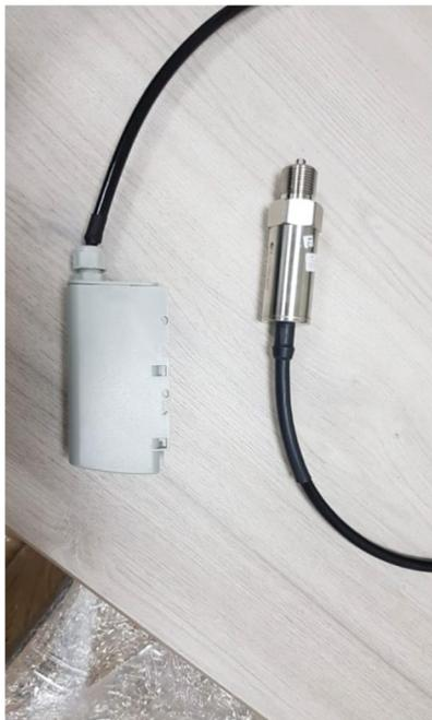
Рис. 7. Макет информационно-измерительного стенда для измерения давления жидкости
