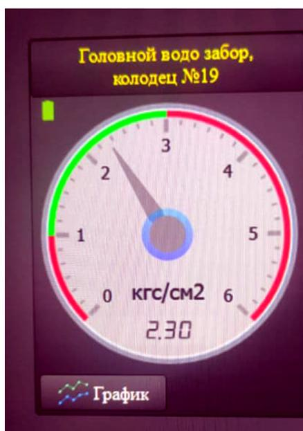
Рис. 10. Визуализация полученных данных с датчика давления
