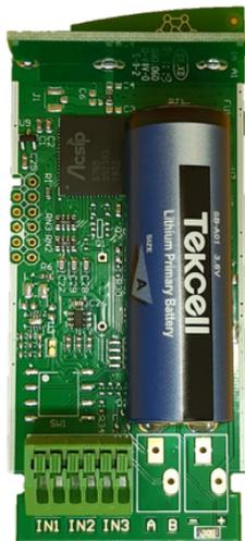
Рис. 4. Печатная плата с электроникой радиомодема ORIONmeter
