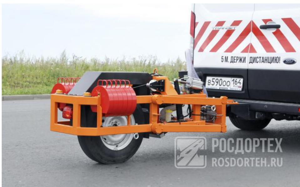
Рис. 3. Толкочмер типа ПКРС-2
