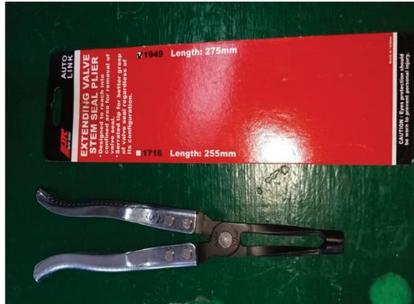
Рис. 2. Съемник маслоотражательных колпачков заводского изготовления марки M1949 Length: 275 мм
