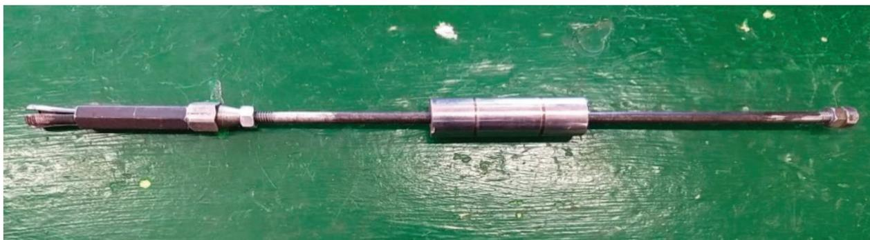
Рис. 4. Съемник маслоотражательных колпачков после апгрейда
