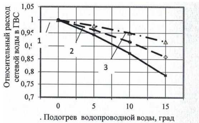
Рис. 1. Зависимость относительного расхода прямой сетевой воды, подаваемой на ГВС от величины подогрева в теплообменнике разбавляющей водопроводной воды. 1, 2, 3 — температура воды разбираемой из кранов ГВС 50 °С, 45 °С, 40 °С
