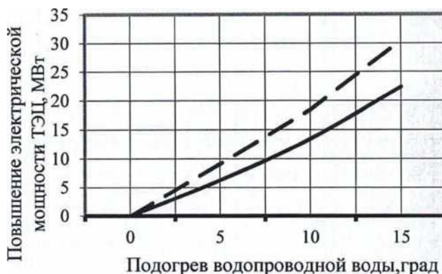
Рис. 2. Зависимость электрической мощности ТЭЦ от относительного расхода сетевой воды подаваемой в системы ГВС. Сплошная линия — относительный расход на ГВС 15 %, пунктирная линия — 20 %
