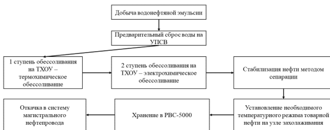
Рис. 2. Процессы подготовки с применением узла захлаживания
