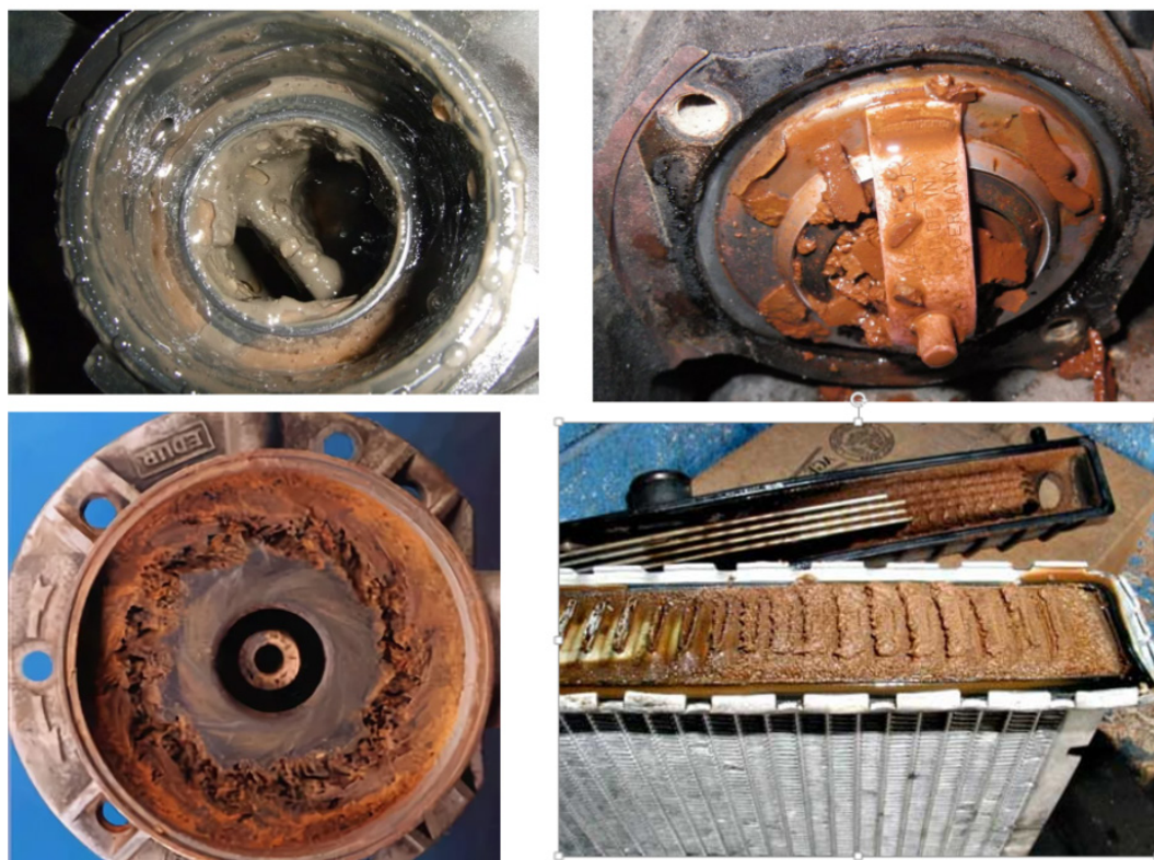
Рис. 1. Типичные неисправности деталей системы охлаждения при использовании воды
