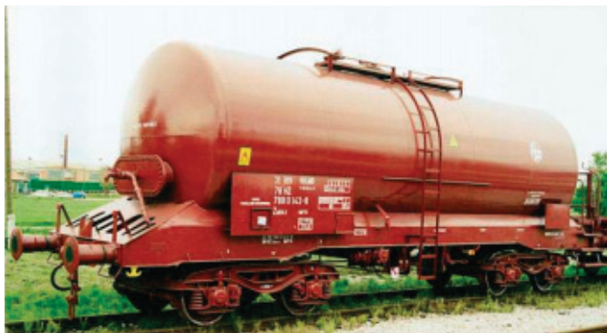
Рис. 11. Вагон-цистерна серии «Z», оснащённая паровыми нагревателями
