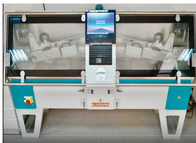
Рис. 3. Установка для испытаний на колеобразование
