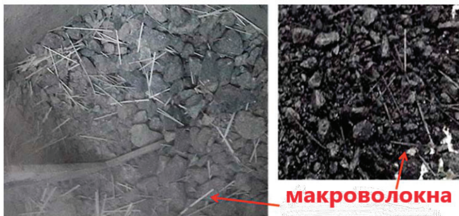
Рис. 2. Распределение макроволокон в процессе смешивания
