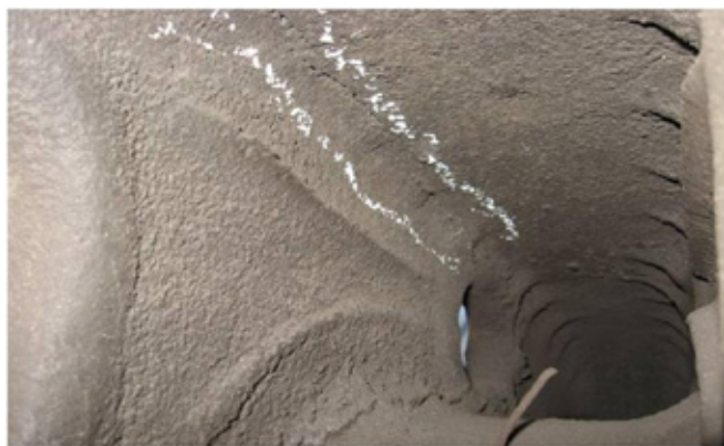
Рис. 5. Фрагмент отливки «Рама боковая» с упрочняющими ребрами и горячей трещиной
