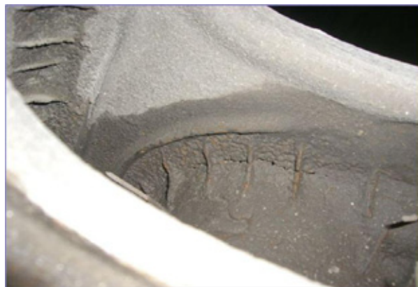
Рис. 6. Фрагмент отливки «Рама боковая» с упрочняющими ребрами и горячей трещиной в термическом узле
