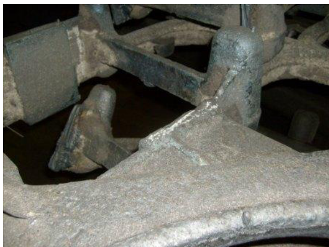
Рис. 2. Фрагмент отливки «Рама боковая» с недоливом ребра, помеченного мелом
