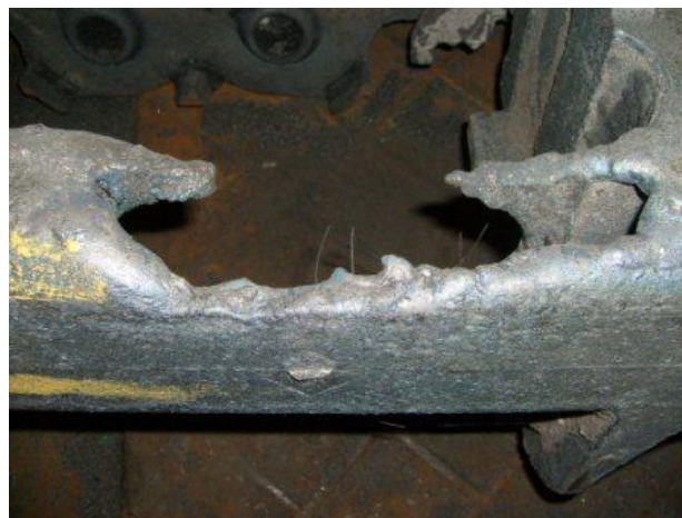
Рис. 1. Фрагмент отливки «Рама боковая» с недоливом металла
