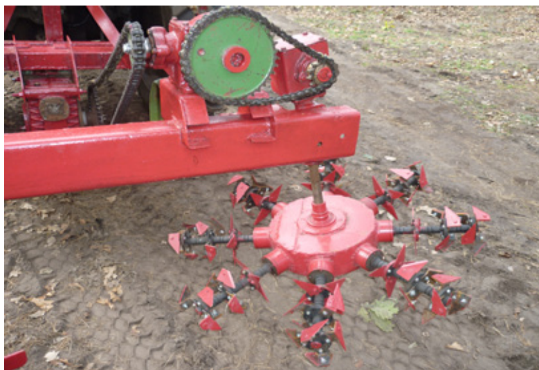
Рис. 1. Экспериментальный образец роторного рабочего органа
