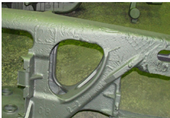
Рис. 3. Фрагмент отливки «Рама боковая», поверхность которой покрыта окисными пленами
