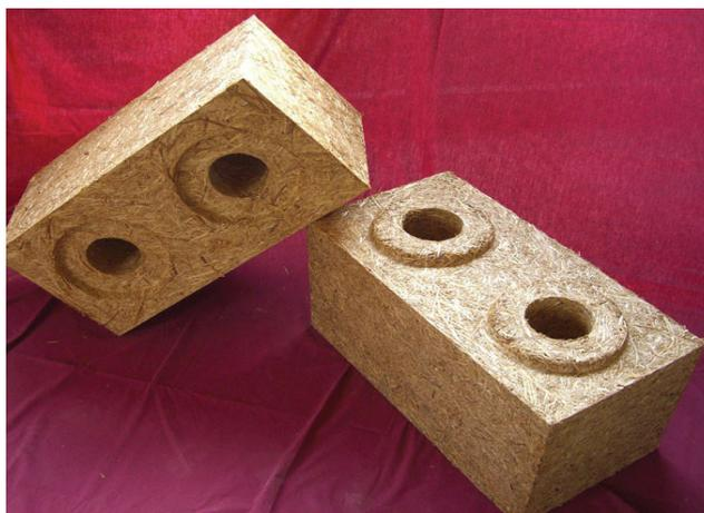
Рис. 1. Горячепрессованный соломенный блок
