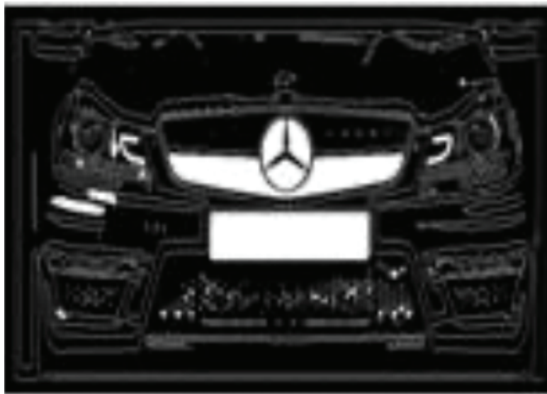
Рис. 3. Изображение после оператора Собеля и выделения непрерывных областей
