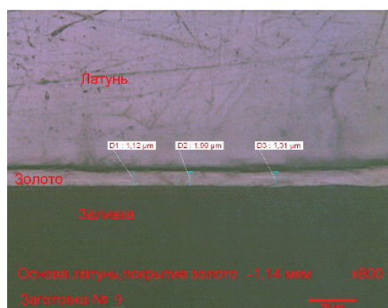
Рис. 8. Золотое покрытие при плотности тока — 0,25 А/дм²
