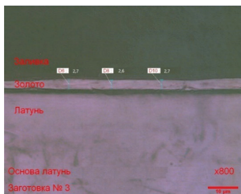
Рис. 3. Золотое покрытие при плотности тока — 0,35 \text{ А/дм}^2
